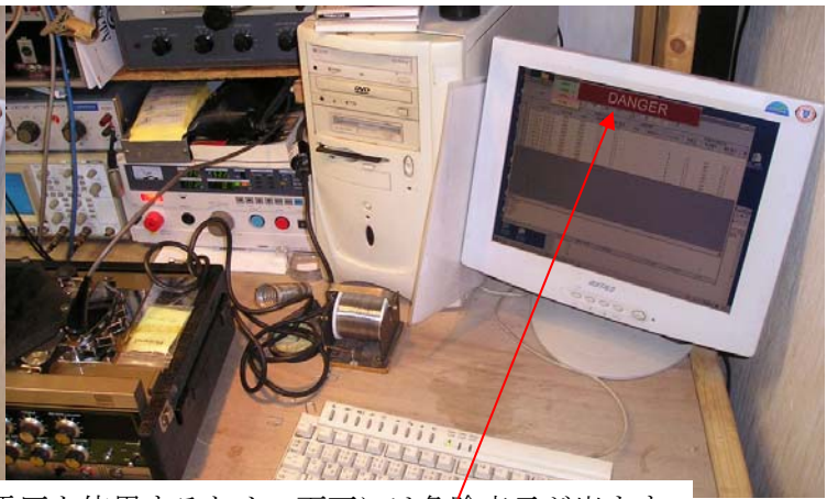
電気試験準備完了と試験開始 1000vもの高電圧を使用するため、画面には危険表示が出ます
